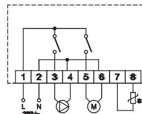
Viene fornita con sonda NTC con 1,5 m di cavo (STLNTSA 150).
