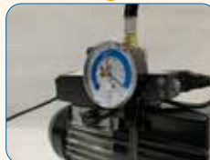
Collegamento con pompa per vuoto
